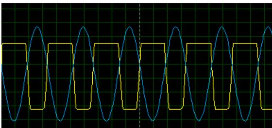
Nótese la señal de salida del optoacploador contenía la información necesaria para saber si el cruce por cero había sido proveniente de un medio ciclo positivo o negativo.
