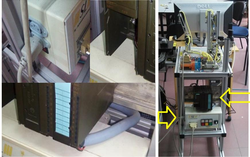
**Figura 37.** El PLC se conecta al módulo de control por la parte trasera y es energizado con 24V DC.
