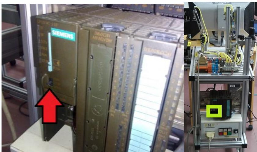
**Figura 2.** Encendido del PLC.
