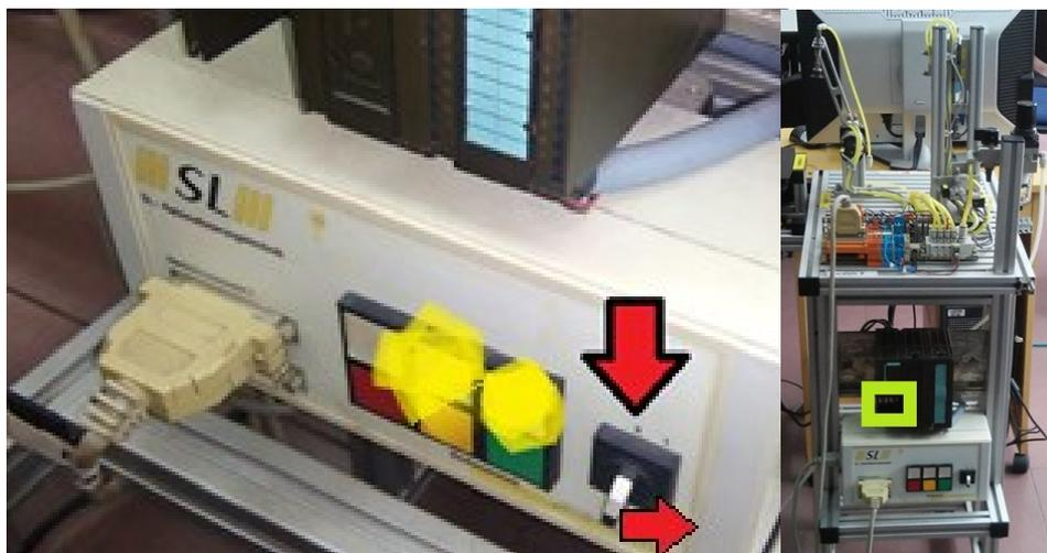
**Figura 6.** La luz de proceso se enciende al detectar la llegada del carro, la cual es simulada con el giro de la perilla a 1.
